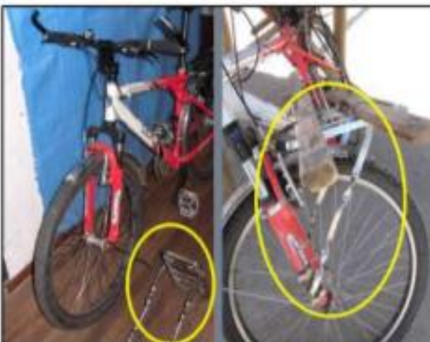
Parrillada frontal artesanal antes (izq) y después (der.) de la instalación en bicicleta con suspensión frontal.
